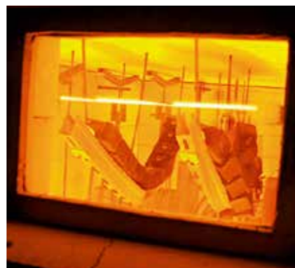
MQ 安装吊挂系统的耐火试验
