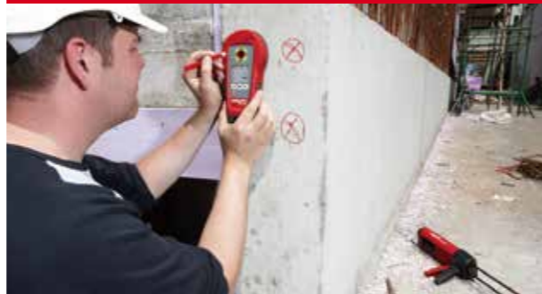
喜利得PS 35测量仪可快速、准确定位混凝土构件内的预埋钢筋位置和保护层厚度
