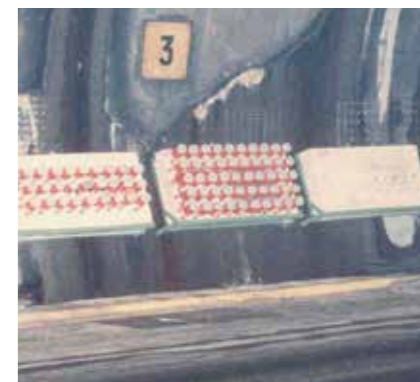
在隧道现场内进行的各类锚栓的腐蚀 研究试验
